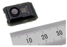
Le capteur infrarouge MelDIR à diode thermique de  $80 \times 60$  pixels (MIR8060C1) dispose d'un champ de vision de  $100^{\circ} \times 73^{\circ}$
