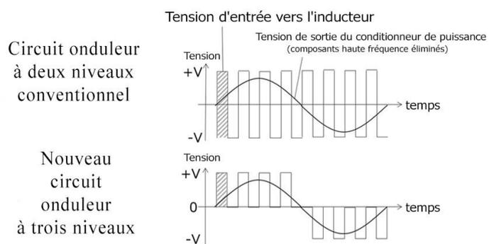
Fig. 4 Réduction de l'amplitude de la tension d'entrée
