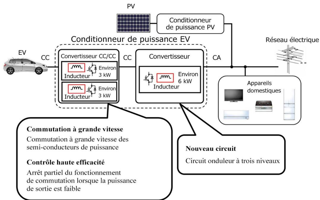
Fig. 2 Configuration du nouveau conditionneur de puissance EV
