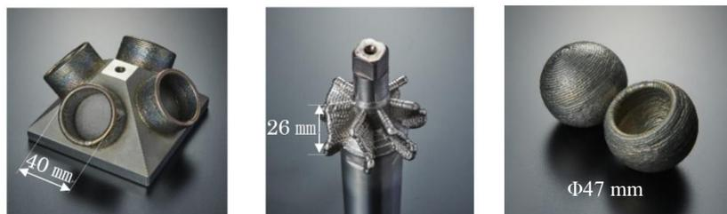
Fig. 4 Exemples de technologie de formation par points
