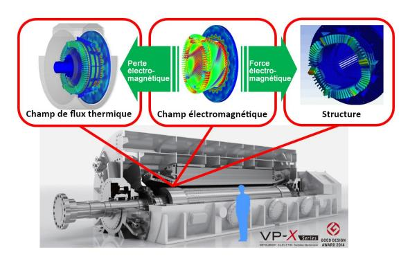
Cette technologie analyse l'interaction entre le champ électromagnétique et le champ de flux thermique, ainsi que les configurations structurelles des groupes électrogènes, ce qui permet d'obtenir la répartition détaillée de la température et le calcul des vibrations à partir de la répartition détaillée des pertes et de la force électromagnétique.
