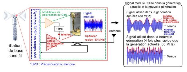
Amplificateur de puissance contrôlé par polarisation dans la nouvelle génération de stations de base sans fil
