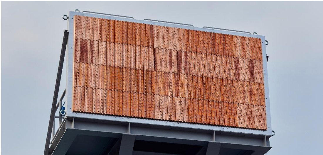
نموذج أولي للهوائي المجهز بمصفوفة ذات دليل موجي المُشكّل بواسطة الحقن بالراتنج
